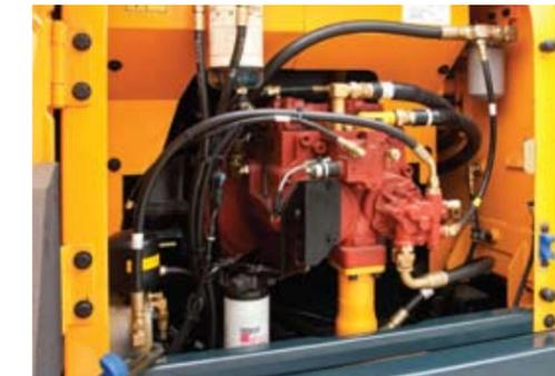
Afin de réaliser une précision optimale, Hyundai a conçu un nouveau système hydraulique pour permettre à l'opérateur un réglage plus fin et une contrôlabilité améliorée. Un contrôle amélioré du flux de la pompe réduit l'écoulement quand les commandes ne sont pas utilisées pour minimiser la consommation du carburant.
