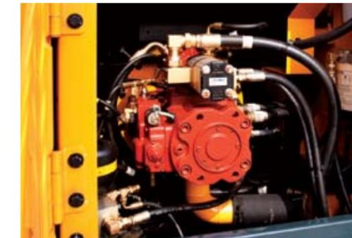
Afin de réaliser une précision optimale, Hyundai a conçu un nouveau système hydraulique pour permettre à l'opérateur un réglage plus fin et une contrôlabilité améliorée. Un contrôle amélioré du flux de la pompe réduit l'écoulement quand les commandes ne sont pas utilisées pour minimiser la consommation du carburant. Des soupapes de débit d'huile améliorées sont conçues pour permettre un flux plus précis à chaque fonction avec moins d'effort.
