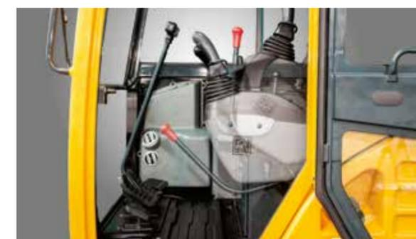
La console gauche peut s'incliner, offrant ainsi à l'opérateur un accès plus aisé à la cabine. Le système de verrouillage de sécurité vise à empêcher toute sortie de la cabine tant que le R18-9 est en cours de marche. Dès que le levier de sécurité et la console gauche sont positionnés à la verticale, les fonctions hydrauliques se désactivent.
