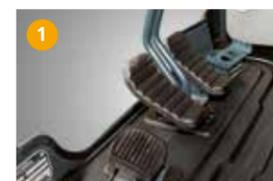
Le repose-pieds, la pédale d'accessoire, les pédales de déplacement gauche et droite et la pédale de la flèche sont agencés pour être accessibles.
