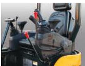
La console gauche inclinable facilite l'accès à la cabine. Un système de verrouillage de sécurité empêche de sortir de la cabine lorsque les commandes hydrauliques sont sous tension. Lorsque le levier de sécurité et la console gauche sont en position verticale, les fonctions hydrauliques sont désengagées.
