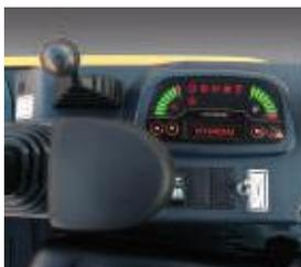
Les leviers de commande gauche et droit sont disposés de façon ergonomique pour un accès aisé. Les manettes actionnables par le pilote sont facilement accessibles de manière à pouvoir contrôler la lame de boteur et l'extension de la chenille. Des commutateurs de commande facilement accessibles situés sur la console gauche améliorent le confort d'utilisation et la productivité.
