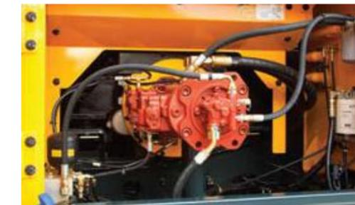
Afin de réaliser une précision optimale, Hyundai a conçu un nouveau système hydraulique pour permettre à l'opérateur un réglage plus fin et une contrôlabilité améliorée. Un contrôle amélioré du flux de la pompe réduit l'écoulement quand les commandes ne sont pas utilisées pour minimiser la consommation du carburant.
