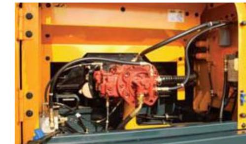
Afin de réaliser une précision optimale, Hyundai a conçu un nouveau système hydraulique pour permettre à l'opérateur un réglage plus fin et une contrôlabilité améliorée. Un contrôle amélioré du flux de la pompe réduit l'écoulement quand les commandes ne sont pas utilisées pour minimiser la consommation du carburant. Des soupapes de débit d'huile améliorées sont conçues pour permettre un flux plus précis à chaque fonction avec moins d'effort.
