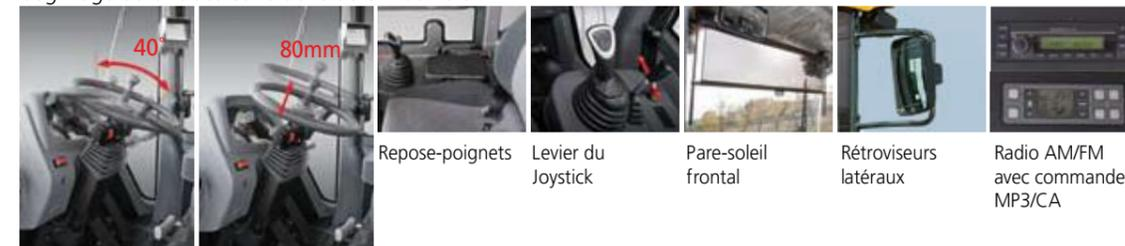
Colonne de direction inclinable / télescopique
