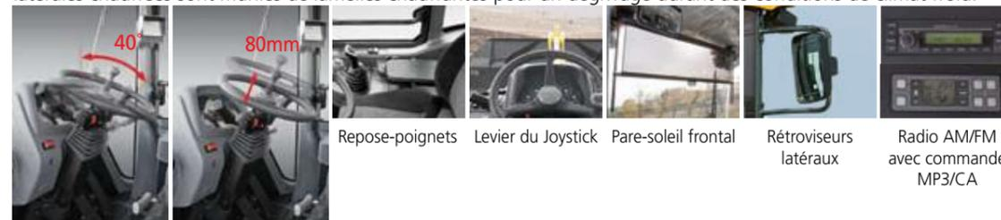
Colonne de direction inclinable / télescopique
